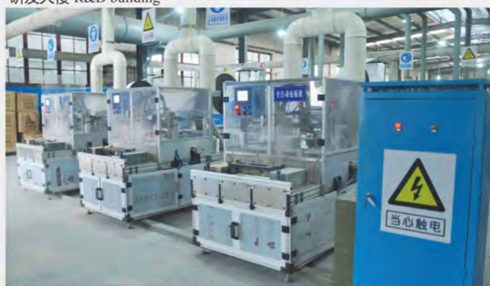
自动包板工序 Automatic wrap plate process
